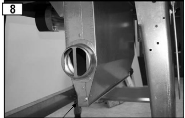
Spanauswurfschlitz geschlossen (Betrieb mit Späneabsaugvorrichtung)
