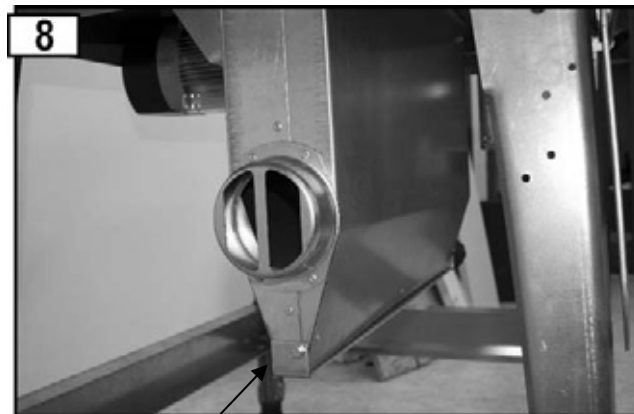
Szczelina do wyrzucania wiórów zamknięta (praca z odsysaniem wiórów)
