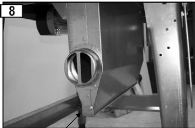
Spanenafvalsleuf gesloten (bedrijf met spanenafzuigvoorziening)
