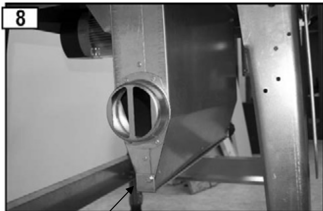
Výhozový otvor pro piliny je uzavřen (použití s odsávacím zařízením)
